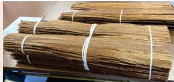
檜皮葺とは、樹齢80年以上のヒノキの立木から、木の成長にもっとも大切な内部の形成層である白い色の部分を傷付けないように、丁寧に剥ぎ取った皮を、一枚ずつ重ねて屋根を葺く、日本古来から伝わる伝統的な屋根工法です。平安時代以降、京都御所にも使われ、出雲大社や厳島神社の屋根などにも用いられるなど格式の高い技法とされています。その最大の特徴が独特の美しい曲線を描く「反り」とされています。
