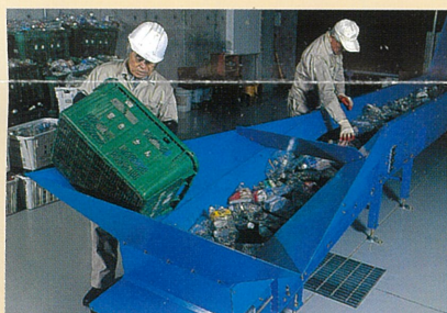
選別コンベヤー
