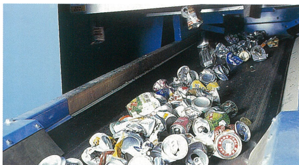
選別コンベヤーとスチールじせんき
