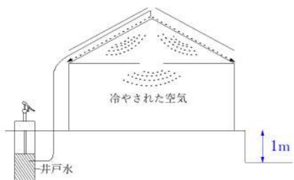
●屋根散水の仕組み
