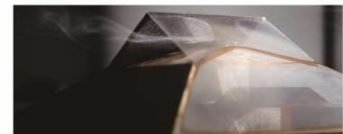
●1/100模型による風洞実験
