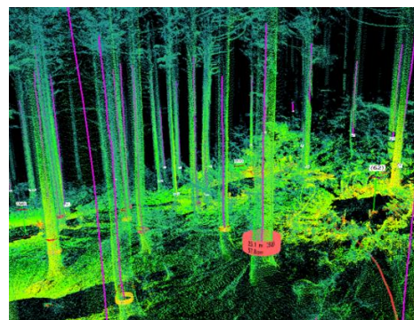
スマート林業の取組 （地上レーザーでの森林資源の解析）
