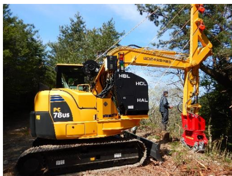
高性能林業機械（架線集材機械）の導入 （主索ウインチ付きスイングヤード）
