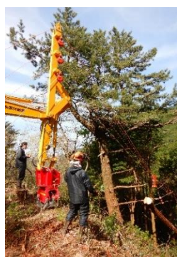
高性能林業機械（架線集材機械）の導入 （主索ウインチ付きスイングヤード）
