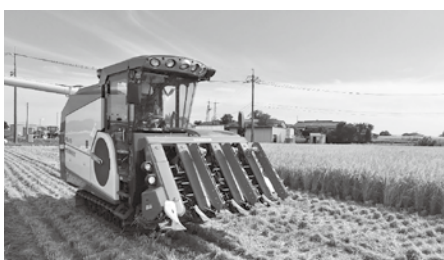
自動運転コンバイン（スマート農機の一例）
