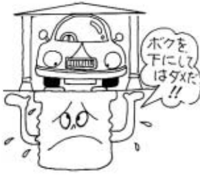
建造物の下の浄化槽は不適
