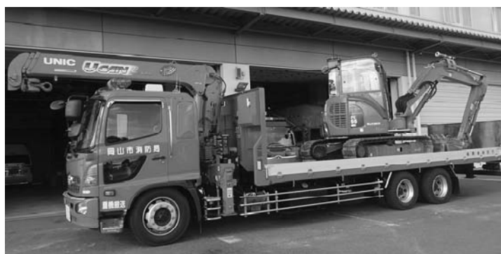
救助用重機・重機搬送車両を配備(常備消防自動車整備事業)
