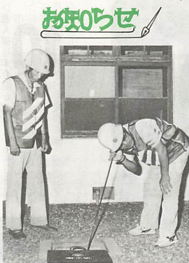
人や車が少なくなった真夜中に、探知棒や機械を使用して漏水調査をする水道局職員
