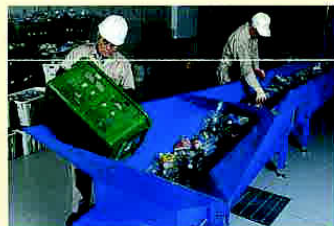
選別コンベヤー
