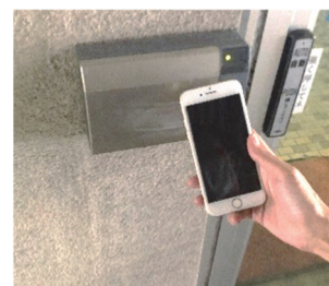
便利で衛生的な施設運営 【スマートフォンを利用したスマートロックの導入】
