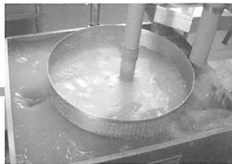
▲30キロずつ洗米され米はパイプを伝い自動的に上の升へあがります
