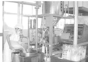
▲お米を自動米炊飯機へ投入、この一つの機械でお米を最後まで仕上げます
