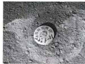
▲写真③(左)写真④(右)、地籍調査区域内のいたるところに打設されています。左は、アスファルトなど、右は、地面用です。
