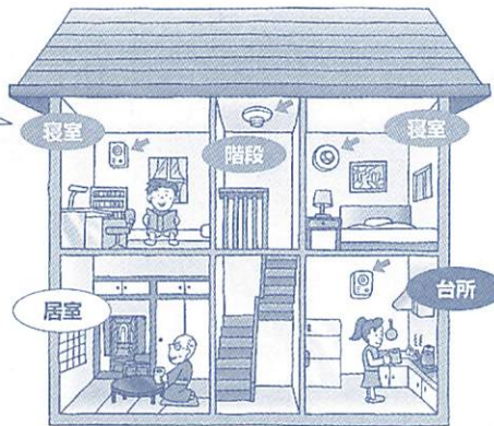
寝室と階段…設置義務があります 台所…設置をお勧めします
