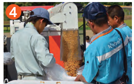
4 その場で、収穫用の機械で飼料用の実とそれ以外に分別される。茎や葉はその場で畑にまかれ、堆肥として利用できる。
