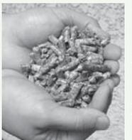
◀燃料に使うのは木質ペレット。木材の製材過程で出る副産物等を圧縮成型した小粒の固形燃料です。
