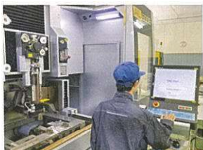
実習設備の例(ワイヤ放電加工機)
