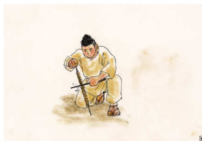
⑦ヤスリで銭の外側のバリを削り取る
