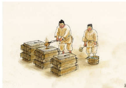
④鋳型を合わせ、溶かした金属を流し込む
