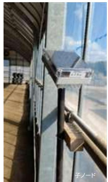
▶温度・湿度・気圧・照度を測定し、無線通信により親機にデータを送信する装置
