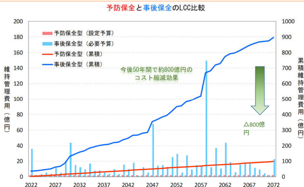
図 3.2 長寿命化修繕計画によるコスト縮減効果（試算）
