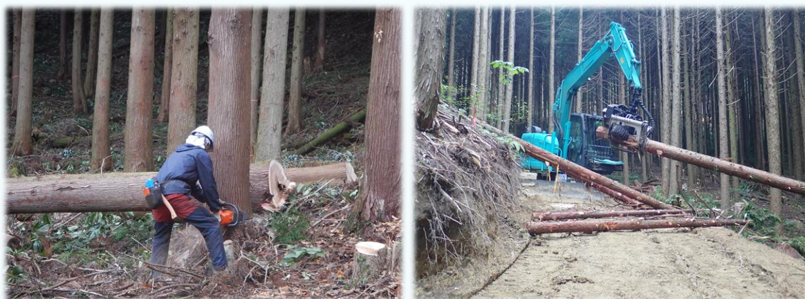
▲チェーンソーによる伐採作業（左）と高性能林業機械を用いた玉切り（右）の様子
